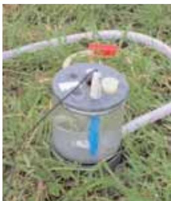
Figura 3.31 - Cella di flusso per la misura dei parametri chimico-fisici dell'acqua
