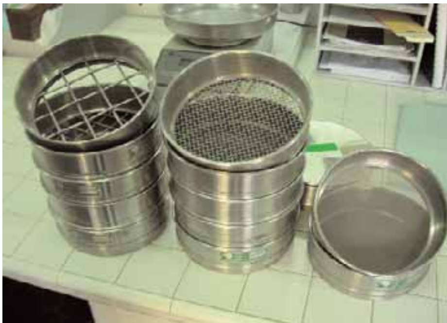
Figura 2.26 - Setacci utilizzati per la determinazione della curva granulometrica del campione. I setacci vengono impilati in ordine decrescente (le maglie più larghe sopra, quelle più strette verso il basso) e sistemate su una piastra vibrante. Il terreno viene quindi suddiviso nelle diverse frazioni e pesato. Il rapporto fra peso dell'aliquota di terreno trattenuto in ogni setaccio e il peso totale del campione, espresso in percentuale viene riportato sulla curva granulometrica
