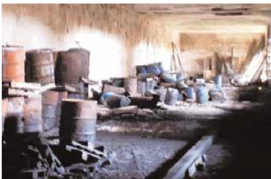
Figura 9.4 - Area di stoccaggio fusti abbandonata con contenitori in metallo e in plastica in pessime condizioni di conservazione
