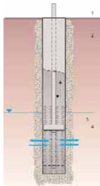
Figura 3.25 - Schema di sviluppo mediante pistonaggio: 1) asta pesante; 2) rivestimento; 3) filtri; 4) pistone
