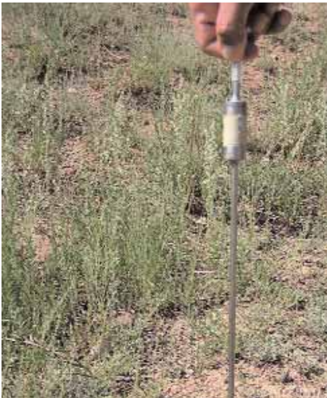
Figura 1.6 - Sistema manuale di infissione per il prelievo dei gas del suolo. Questo metodo estremamente rapido ed economico può essere utilizzato solo in presenza di terreni non litoidi e per profondità inferiore a 1,5 m. I gas del suolo vengono aspirati attraverso le fessure mediante una pompa da vuoto collegata all'asta da una tubazione in plastica (polietilene o teflon) e vengono poi convogliati in recipienti di raccolta o direttamente agli strumenti di misura
