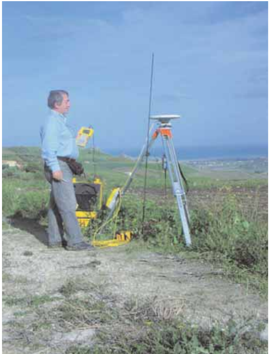
Figura 6.3 - Stazione GPS. Sul treppiedi è innestata l'antenna che riceve i segnali dai satelliti e li invia ad una interfaccia
