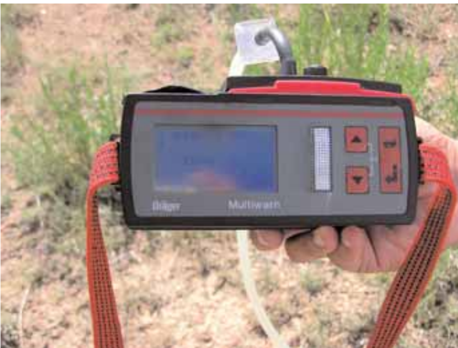
Figura 1.13 - Campionamento attivo dei gas. Alcuni strumenti portatili di misura sono dotati di una pompa interna per l'aspirazione dei gas del suolo; in tal caso lo strumento (nella foto un analizzatore per CO 2 , CH 4 e O 2 ) si collega direttamente all'asta cava mediante una tubazione in PE o Teflon
