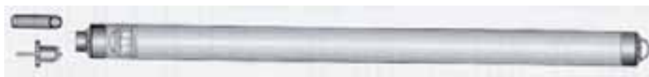
Figura 3.34 - Bailer monouso. E' visibile l'anello sommitale per il collegamento ad una corda, la sfera che funge da valvola, libera di scorrere nel corpo del bailer, e due tipi di raccordo per lo svuotamento del bailer: uno più grande per il riempimento di bottiglie di grande capacità e uno più piccolo per il riempimento di fiale di piccole dimensioni con minima esposizione del campione all'aria (da Waterra Pumps Ltd.)
