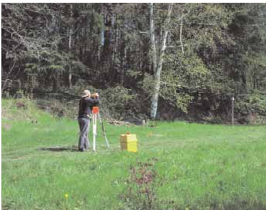
Figura 6.2 - Rilevamento mediante teodolite e palina.
