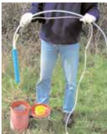
Figura 3.36 - Pompa sommersa con alimentazione elettrica da batteria 12V
