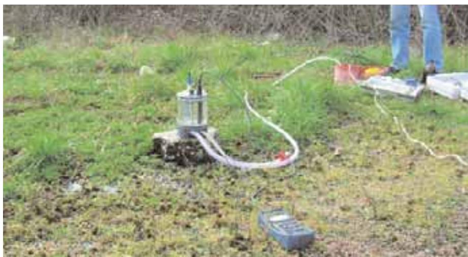
Figura 3.32 - Misura dei parametri chimico-fisici della falda mediante cella di flusso durante le operazioni di spurgo
