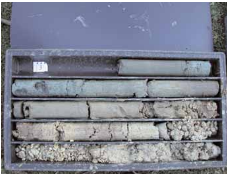
Figura 2.22 - Casseta catalogatrice con carota di terreno. Può essere di legno o materiale plastico e serve a riporre la carota per tutto il tempo necessario al geologo di campo per effettuare il prelievo di campioni di terreno o gas interstiziali, l'analisi delle proprietà organolettiche, le valutazioni sul tipo di granulometria e grado di umidità e, da ultimo, le foto. Le cassette devono recare, oltre al codice del sondaggio di provenienza, l'indicazione dell'intervallo di profondità carotato (ad es. da 0 a 4 m) e, possibilmente, delle profondità parziali di ciascuno spezzone di carota contenuto. Nel caso non venga espressamente richiesto di conservare la carota, questa può essere impiegata per riempire il foro di sondaggio o smaltita secondo quanto previsto dalle norme
