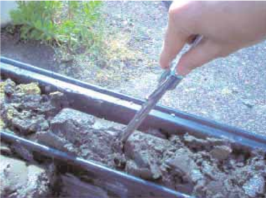
Figura 2.30 - Prelievo di terreno per analisi di COV. Si utilizza una “siringa” metallica che viene infissa nella carota di terreno per prelevare il campione. L’espulsione di quest’ultimo avviene per mezzo dello stantuffo della siringa direttamente nel contenitore di vetro ( vial )
