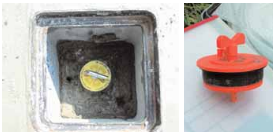
Figura 3.17 (a sinistra) - Testa pozzo racchiusa in chiusino carrabile e dotata di tappo lucchettabile a chiusura ermetica
