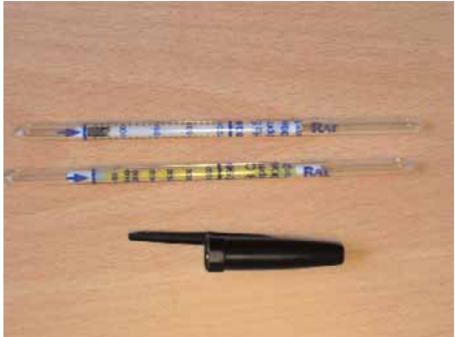
Figura 1.14 - Fiale colorimetriche per la misura in campo delle concentrazioni di determinati composti volatili
