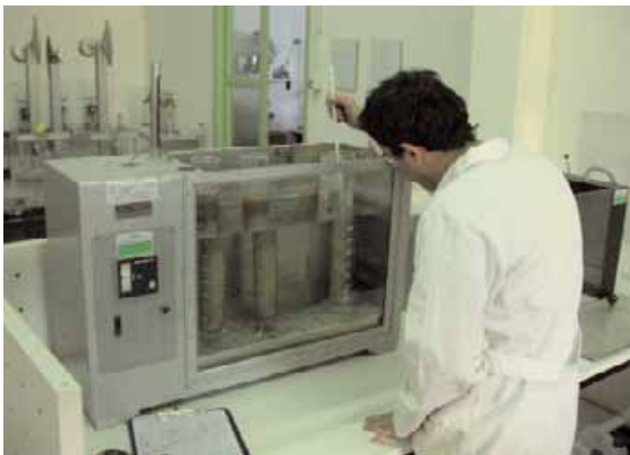
Figura 2.27 - L'analisi granulometrica delle frazioni di terreno minori di 0,075 mm è effettuata per sedimentazione (metodo aerometrico). Il passante al setaccio più piccolo è mescolato in acqua, ottenendo una sospensione che viene lasciata decantare. Misurando di tanto in tanto la densità della sospensione (con l'aerometro, in figura) e nota la legge di Stokes che determina la velocità di sedimentazione in funzione del diametro della particella, si ottiene il diametro delle particelle ancora in sospensione e quindi la ricostruzione della curva granulometrica dei fini
