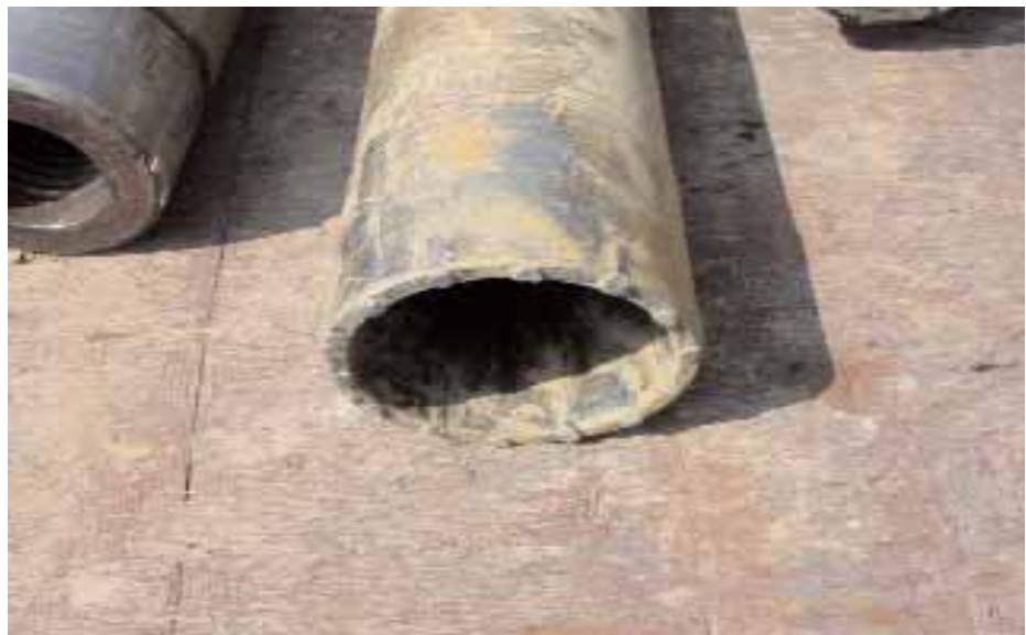
Figura 2.8 - Particolare di corona con denti al widia (carburo di tungsteno) montata su carotiere semplice dal diametro di 101 mm
