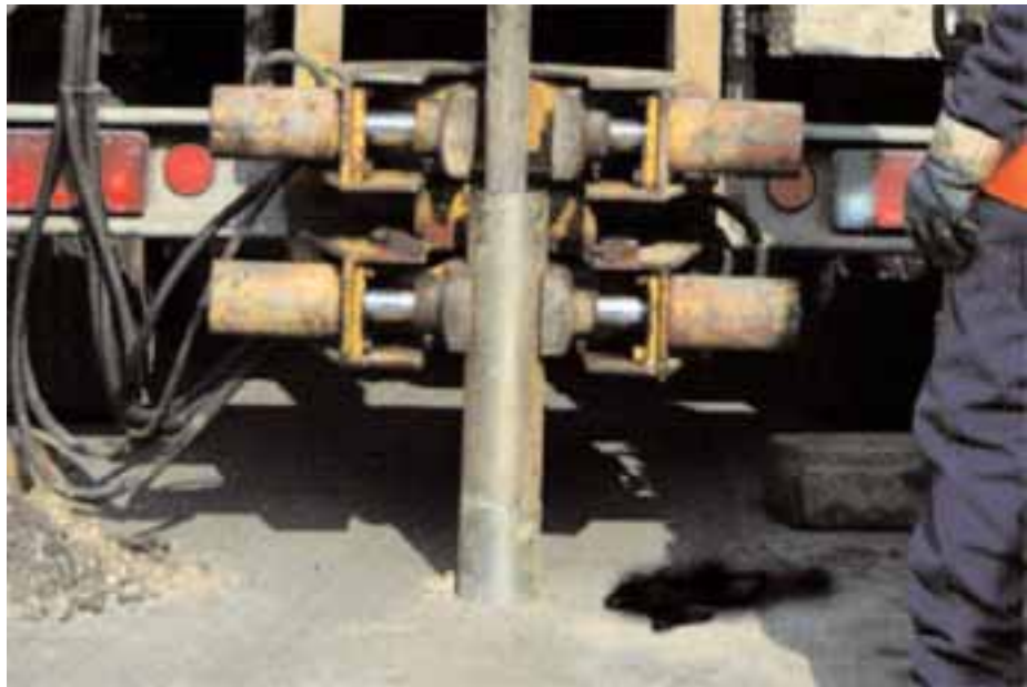
Figura 7.6 - La scarsa manutenzione della sonda può provocare la perdita di olio dai circuiti idraulici che può compromettere il risultato finale del campionamento
