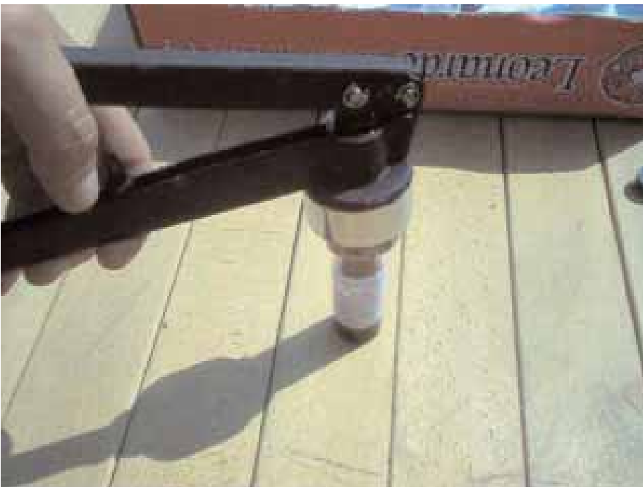
Figura 2.31 - Chiusura di una vial con tappo ermetico. Il tappo è costituito da un setto in gomma che assicura la tenuta dei gas e da un corpo metallico che viene bloccato sulla testa della fiala. L’operazione viene eseguita per mezzo di un’apposita pinza
